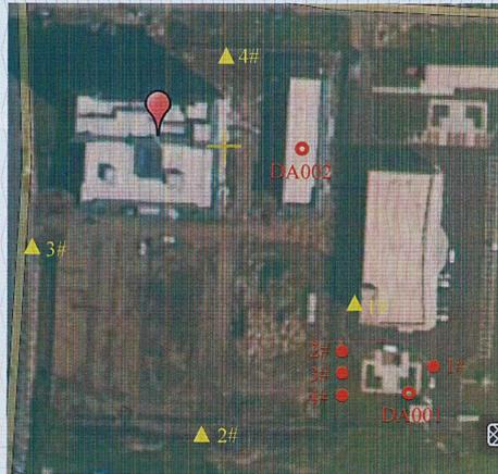
备注：◎代表有组织废气采样点位；●代表无组织废气采样点位；▲代表噪声监测点位
